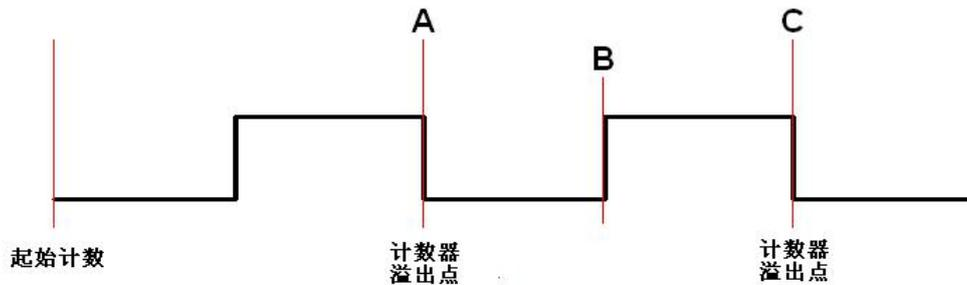
看门狗计数器在 A 点溢出，由于处于“掉电模式”，不响应溢出。A 点的溢出标志将会被保留到 B 点。如果在 B 点前，退出了“掉电模式”会立刻监测到看门狗溢出。如果是在 B 点后退出“掉电模式”，则只能等到 C 点溢出时才响应新的溢出。
