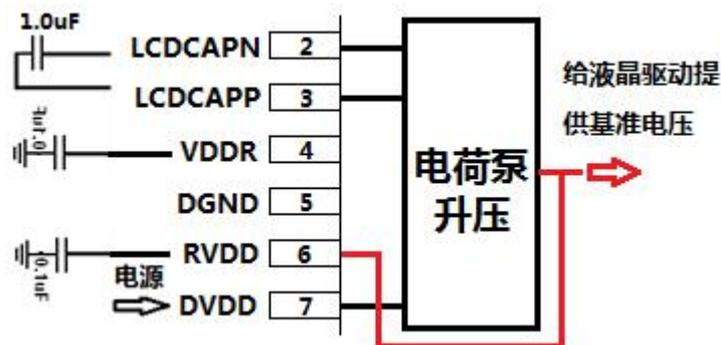
SDI5221-X1 内部集成升压电荷泵，可以将 DVDD 输送来的低电压升压，并稳定输出到 RVDD。使用升压电荷泵请注意：
