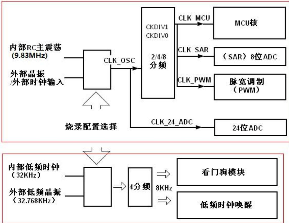
SDI5221 系列的时钟分为两部分：“主震荡”和“低频时钟”，两者均可在烧录时配置是否采用外部晶振，外部震荡管脚和 P1.1, P1.2 复用。（任何时候，只能有一个时钟被配置为外部晶振）
